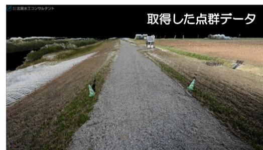
新設の樋門等を竣工時から継続して計測し、経年的な沈下等の変化量を把握
