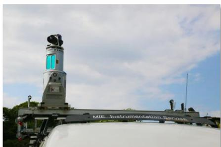
ロングレンジ(1,000m 計測可能)のレーザースキャナーを車載する事で、機器ポジションを高くする事ができ、より広範囲に計測が可能になります。
