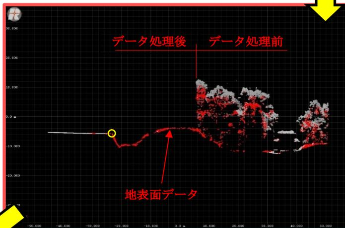
断面計測（樹木フィルタリング処理後）
